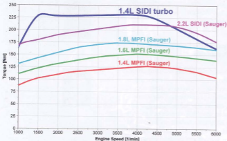
Bild 2: Vollastvergleich zwischen Saug- und Turbomotoren
